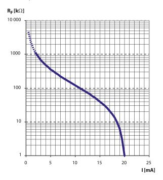
$$R_F = \; \frac{20 \; mA \; x \; 120 \; k\Omega}{I} \; \; \text{-} \; 120 \; k\Omega \label{eq:RF}$$
